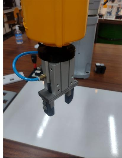
Fig. 4: Garra pneumática
